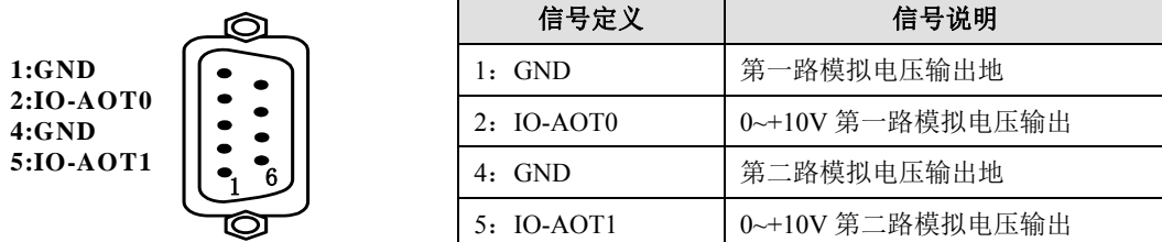
图 2-3-6 模拟电压输出接口
