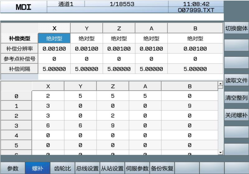
图 4-7-10-2 螺距补偿示例（负向移动补偿值）
